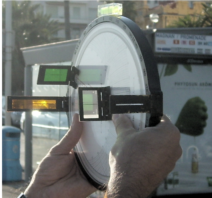
Fig. 2-2. - Mesure de la hauteur à l'aide d'un niveau à bulle.
